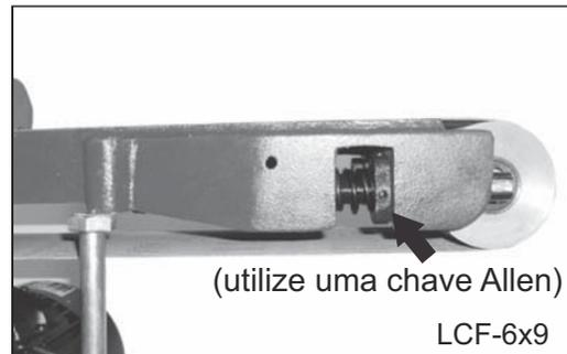
Se perceber que a lixa de cinta estiver muito apertada ou solta, ou inclusive fora de centro, utilize uma chave Allen para o modelo LCF-6x9, ou ajuste manualmente na manopla no modelo LCF-4x6, para um funcionamento adequado da lixa.
