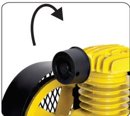
**ATENÇÃO:** Este procedimento é obrigatório para o compressor funcionar corretamente e evitar acidentes. O filtro de ar deve ser colocado antes da primeira utilização do compressor. Nunca utilize o compressor sem o filtro de ar.
