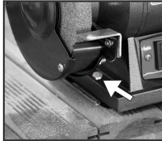
Fig. 6 – Fixação em bancada
