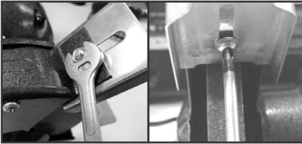
Fig. 2 – Montagem do Protetor visual
