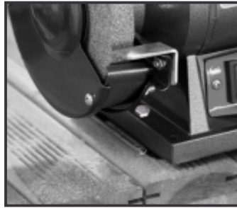
Fig. 6 — Fixação em bancada
