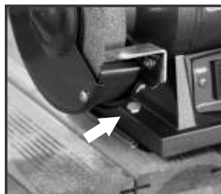
Fig. 6 – Fixação em bancada
