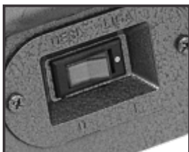
Fig. 5 – Interruptor de acionamento liga e desliga
