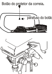
Fig. 9: Rosquear as hastes (2) no pinhão do eixo (21), girando no sentido horário.
